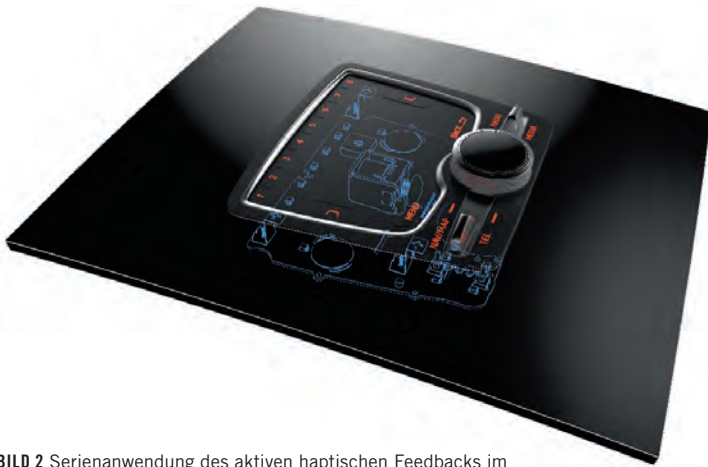
BILD 2 Serienanwendung des aktiven haptischen Feedbacks im MMI-all-in-touch-Bediensystem des Audi Q7 (© Preh)
