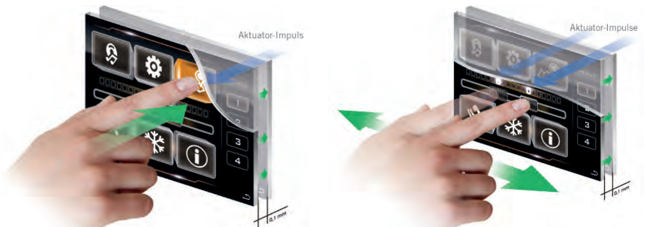
BILD 5 Mittels aktiver Haptik wird beim Touchscreen ein Feedback erzeugt, das sich ähnlich einem Tastendruck anfühlt (links); damit lassen sich auch Schieberegler realisieren (rechts) (© Preh)
